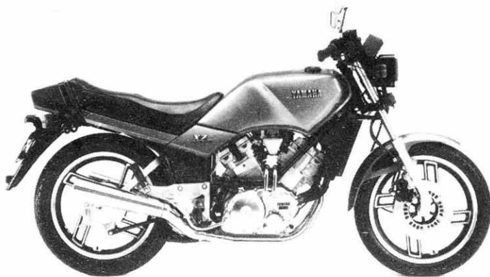
Yamaha XZ 550 Zweizylinder – V – Motor Wasserkühlung, Cantilever Kardanwelle.
