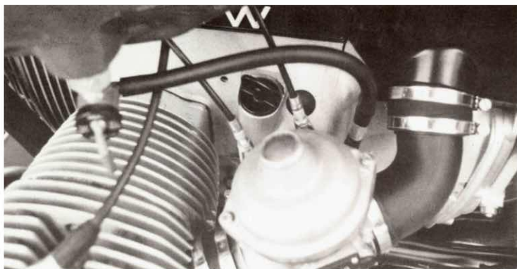
Gut getarnt ist nach wie vor der Öleinfüllstutzen
