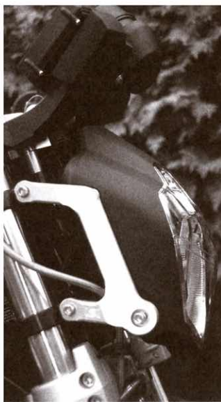
Gefräste Lampenhalterung, andere Scheinwerfermaske und viele liebevolle Details verleihen der Roadster ein eigenes Gesicht.
