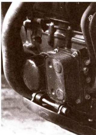
Nach 3000 Kilometern ist der Motor durch den aufgewirbelten Dreck des Vorderrades deutlich in Mitleidenschaft gezogen. (Fotos: Lenzen)
