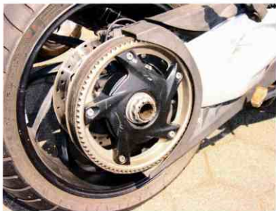
Zahnriemenantrieb und Getriebe arbeiteten unauffällig. Nur der Wechsel des Riemens war richtig teuer. (Foto: Lonnendonker)
