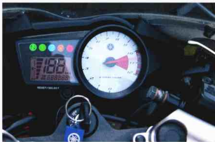
Zentrales Instrument im Cockpit ist der weiß unterlegte Drehzahlmesser, den der Fahrer auch immer im Blick behalten sollte. (Fotos: Lenzen)
