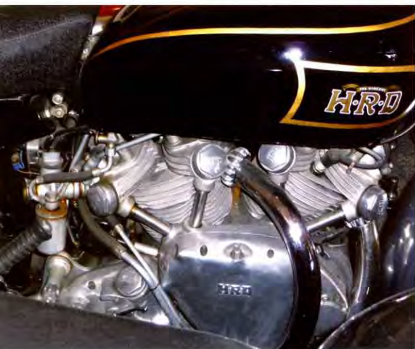
Vincet HRD, Modell Rapide B, 1 Liter Hubraum, 45 PS bei 5.300 U/min., Baujahr 1948. Die zwei Zylinder stehen zu einander im Winkel von 47 Grad. (Fotos: Orlowski)
